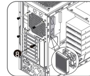
8) Fije el condensador al chasis con los tornillos.
