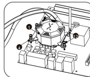
7) Para plataforma AMD, ponga la bomba de agua (con el soporte AMD fijado) sobre la CPU, después fije la bomba de agua a la placa con los 4 pernos AMD.
