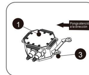
2) Coloque el lado cóncavo de los dos soportes AMD hacia la base de bronce, y ponga el soporte en el canal de la bomba de agua.
