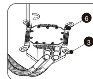
3) Fije el soporte Intel / AMD a la bomba de agua con los 4 tornillos tal y como indica la dirección del diagrama.
