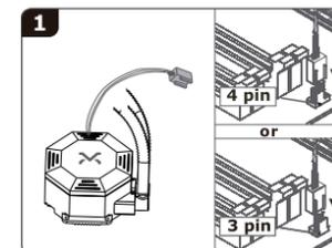
9) Conecte el cable de alimentación de la bomba de agua y el ventilador al conector de 3 ó 4 pines de la placa.
