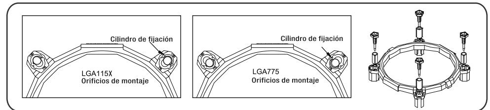
Elija los orificios de montaje apropiados en función del zócalo del procesador.
