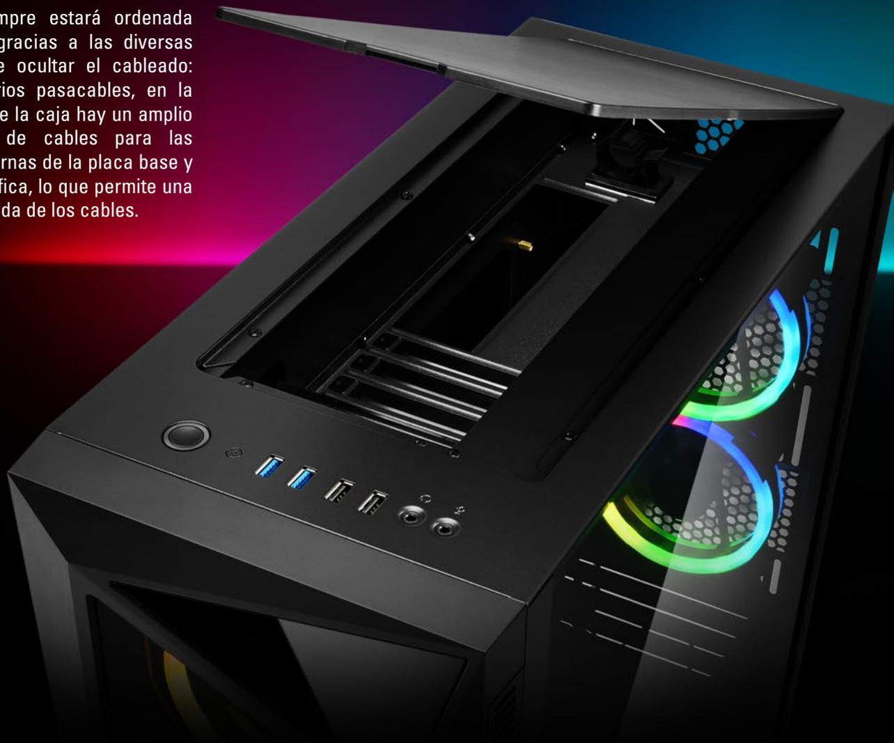
En este caso, los cables se sujetan con un clip para cables y se conducen al exterior de la carcasa a través de un pasacables. El panel superior tiene una cubierta magnética para un fácil acceso al compartimento de cables y para protegerlo de la suciedad y el polvo.
