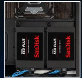
Soporte de montaje para hasta dos 2,5" HDD/SSDs
