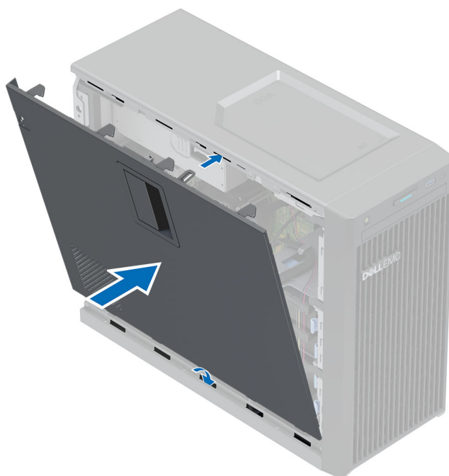
Ilustración 9. Instalación de la cubierta del sistema
