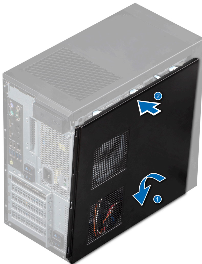
Ilustración 11. Instalación de la cubierta del sistema
