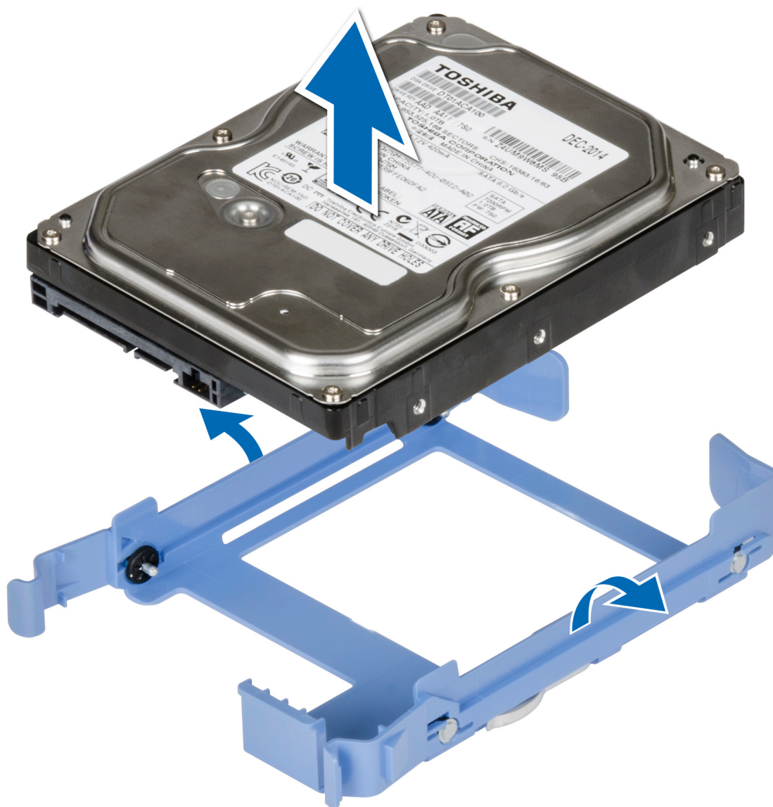
Ilustración 16. Extracción de una unidad del portaunidades
