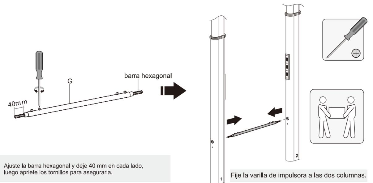
Ajuste la barra hexagonal y deje 40 mm en cada lado, luego apriete los tornillos para asegurarla.
